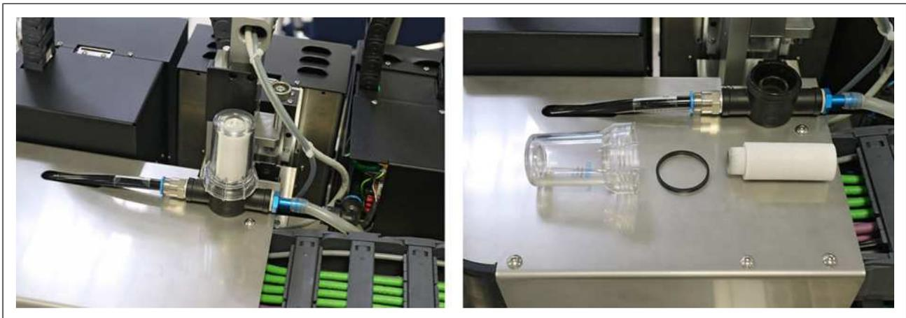
Abb. 11: Vakuumfilter Ort und Vakuumfilter Teile
