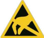
Elektronische Bauelemente können durch elektrostatische Entladung beschädigt werden. Beachten Sie bitte die Warnhinweise auf den Verpackungen oder fragen Sie den Hersteller oder Lieferant. Zum Schutz dieser Bauelemente eignet sich ein ESD-sicherer Arbeitsplatz (ESD = Elektrostatische Entladung).
