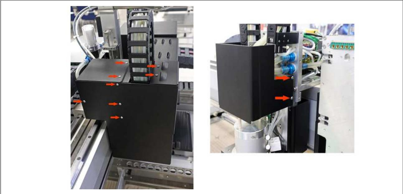
Abb. 15: Verkleidungsbleche der Restlotabsaugung abschrauben
